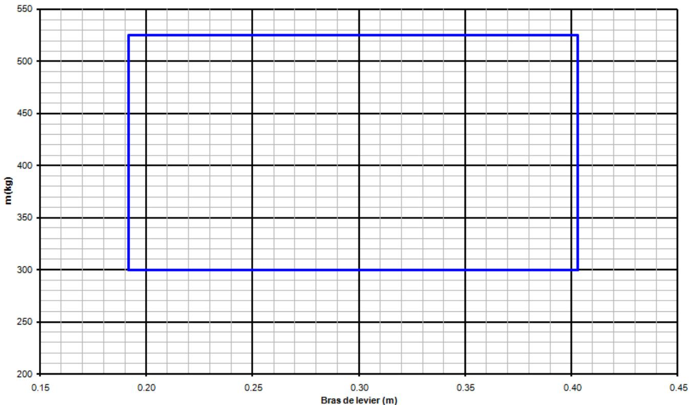
cma = 960 mm ; référence de centrage bord d'attaque aile Détermination du centrage
